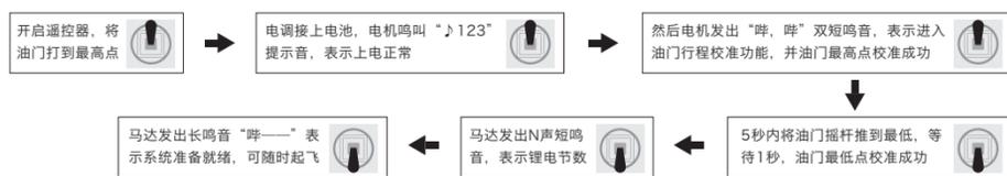
注意：电调的油门行程出厂默认值为1100μs~1940μs (Futaba标准)，当首次使用电调或者更换其他遥控器使用时，均应重新设定油门行程。
